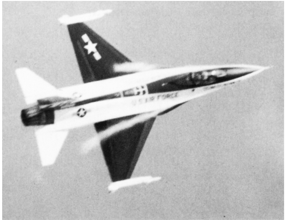
F-16 beim Abfangvorgang; durch den Unterdruck im Kern des Strakewirbels kondensiert die Luftfeuchtigkeit aus.
