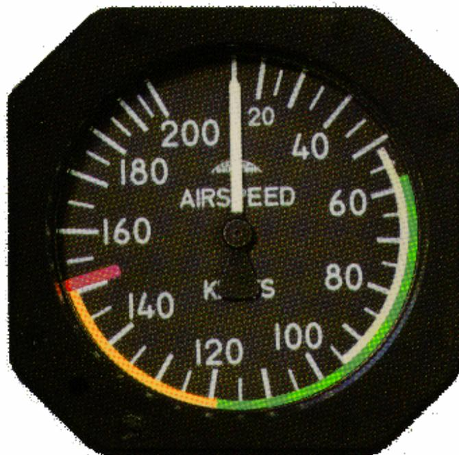
Die für die Festigkeit und Flugeigenschaften eines Luftfahrzeuges wichtigen Geschwindigkeiten und Geschwindigkeitsbereiche werden am Fahrtmesser übersichtlich markiert.
