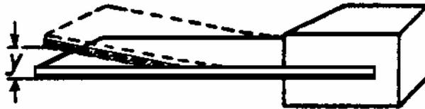
Diese Fehler werden, vor allem beim Höhenmesser, durch Einfügen von Bimetall-Temperaturkompensatoren beseitigt. Bimetallstreifen werden durch Verbinden (Walzen, Lötten u.s.w.) von Metallen mit sehr unterschiedlichen Wärmeausdehnungskoeffizienten hergestellt (z.B. Invar{Stahl+36% Nickel}/Stahl, Invar/Messing).
